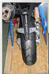
Imballaggio per motocicli, studiato per il trasporto in container con possibilità di sfruttare 2 piani in altezza. Bancale in legno con stocchetti guida per ruota posteriore, fresata anteriore per incasso ruota e compressione dell'avantreno tramite cinghie ad alta resistenza. Chiusura con cartone tripla onda.
