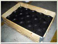
Studio per movimentazione interna elettropompe. Sagomatura di plateaux in ppl su diverse misure componenti con relativi sistemi di bloccaggio in assi di legno perforati.
